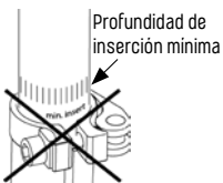
Fig. 2/14 Profundidad de inserción
