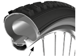
Extracción de la cámara
