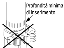
Fig. 2/15 Profondità di inserimento
