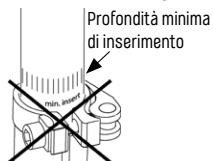
Fig. 2/15 Profondità di inserimento
