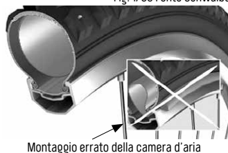
Montaggio errato della camera d'aria
